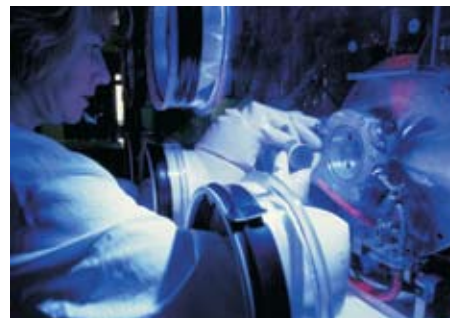
Öffnung eines Behälters zur Aufnahme von Plutoniumproben.
