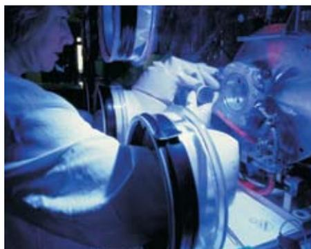
Ouverture d'une source pour l'insertion d'échantillons de plutonium.
