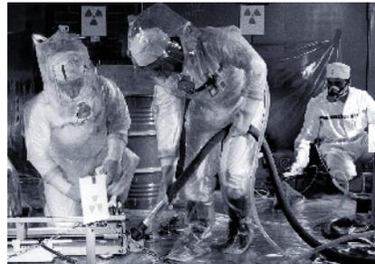
Manipulation d'aiguilles de combustible – mesures de sécurité.
