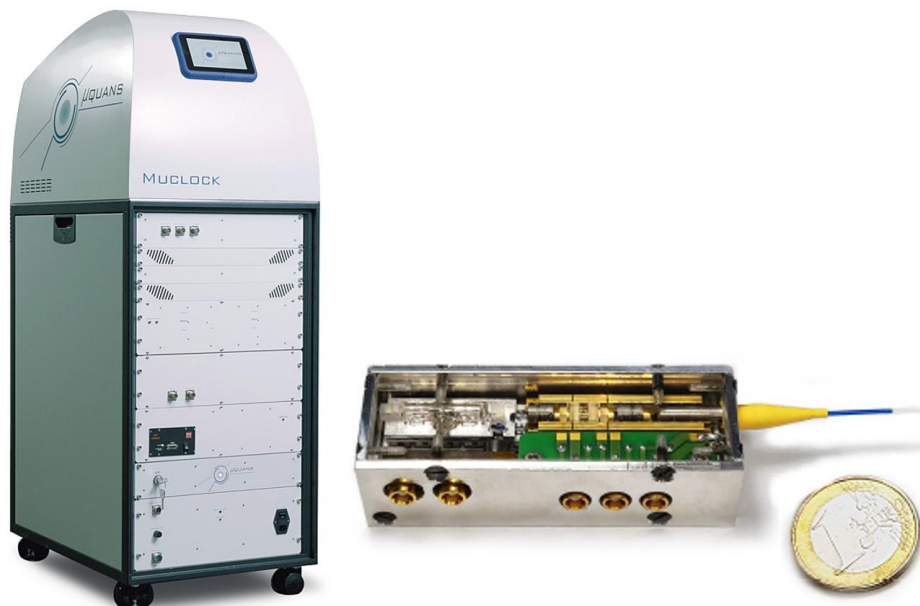
Figura 61 – Un orologio commerciale ad atomi freddi (a sinistra) e un prototipo di standard di frequenza ottica basato sulla transizione a due fotoni in rubidio (a destra). Si noti che in quest'ultimo caso non è incluso il pettine di frequenza necessario per tradurre la frequenza ottica stabilizzata in un segnale a microonde [Strangfeld 2021]
