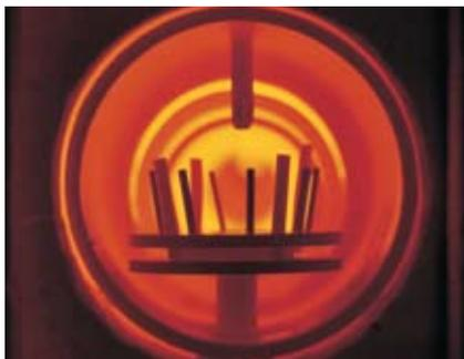
Materiali avanzati vengono testati in un bruciatore di laboratorio.
