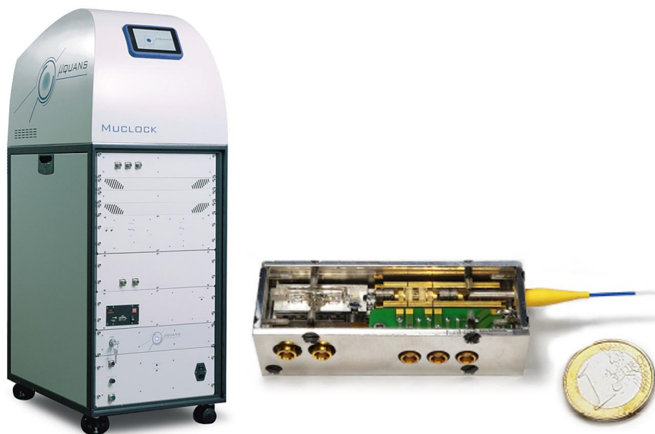
Abbildung 61 – Eine kommerzielle Kaltatom-Uhr (links) und der Prototyp eines optischen Frequenznormalis auf der Grundlage des Zwei-Photonen-Übergangs im Rb (rechts). Es sei darauf hingewiesen, dass der Frequenzkamm, der zur Umsetzung der optisch stabilisierten Frequenz in ein Mikrowellensignal erforderlich ist, nicht enthalten ist [Strangfeld 2021].
