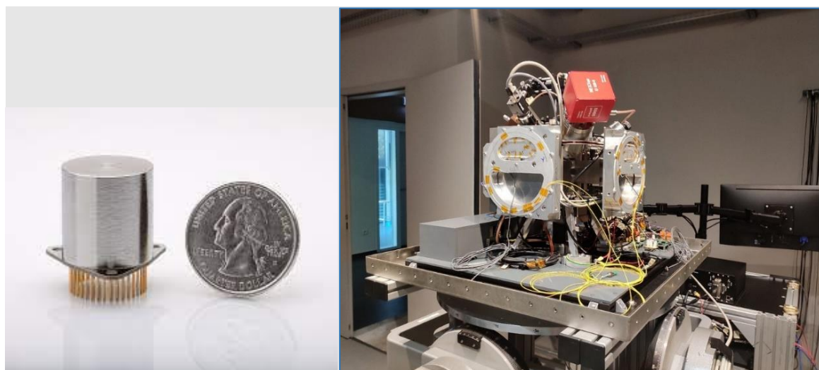
Illustration 62 — Un prototype de gyroscope à RMN pour applications tactiques de Northrop Grumman (à gauche) et une unité de mesure inertielle de laboratoire développée par IXblue par hybridation de gyromètres à fibre optique et d'accéléromètres CAI (à droite)
