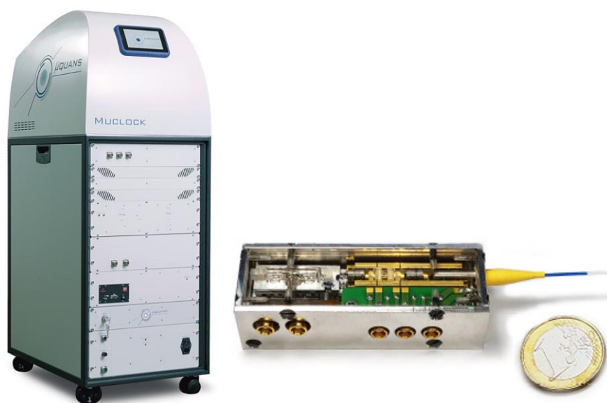
Illustration 61 — Une horloge à atomes froids commerciale (à gauche) et un prototype d'étalon de fréquence optique basé sur une transition à deux photons au rubidium (à droite). À noter que ce dernier n'inclut pas le peigne de fréquences nécessaire pour traduire la fréquence optique stabilisée en signal micro-ondes [Strangfeld 2021]
