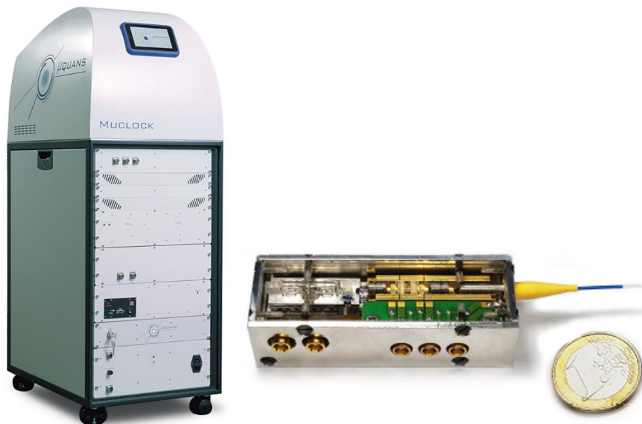
Gráfico 61. Un reloj de átomo frío comercial (izquierda) y un prototipo de patrón óptico de frecuencia basado en la transición de dos fotones en el rubidio (derecha). Obsérvese que en este último no se incluye el peine de frecuencias necesario para traducir la frecuencia óptica estabilizada en una señal de microondas [Strangfeld 2021]
